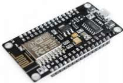
**Fig 2 Arduino NodeMCU**
